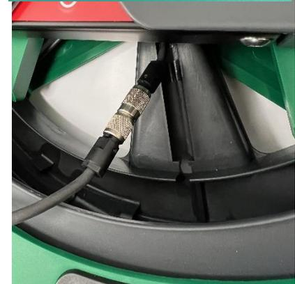
6. Schrauben Sie den Kabelstecker vom Trommelanschluss ab.
